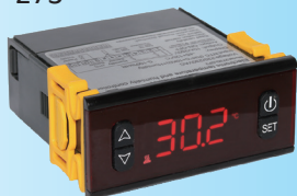
Elektronischer Regler mit 77x35mm- Einzelanzeige, EIN/AUS
